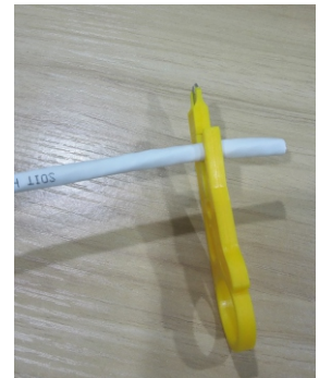
3、线缆外皮剥除 20~25mm
