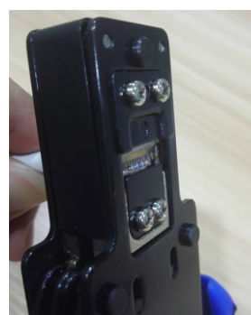
9、压接时工具自动切除多余线缆
