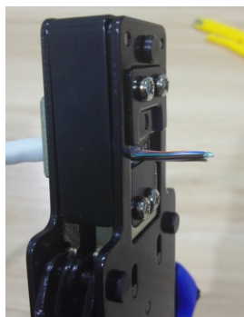
8、水晶头安放到位后进行压接
