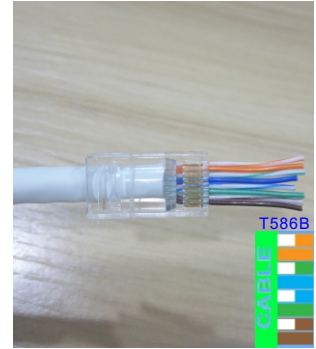
6、将线缆推入水晶头，再次检查线序
